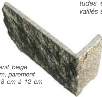
*Angle évidé : -40kg/ml, en granit beige grain fin, Hauteur de 13 à 20 cm, parement éclaté 20 à 25 cm et tête de 8 cm à 12 cm environ*
